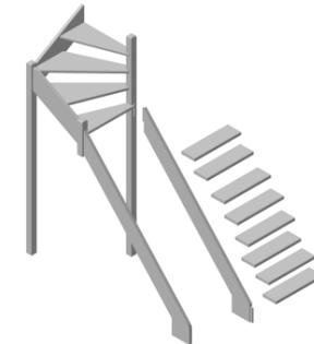
5. Между нижними струнами, с шагом 223 мм, последовательно монтируют нижние ступени 705x205 мм (поз. 6). Крепление к струнам посредством металлических уголков и саморезов 3,5x35 мм.
