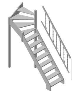
7. Отдельно собирают конструкцию из основы балясин (поз. 14), поручня (поз. 16) и семи балясин (поз. 15). Между собой их скрепляют саморезами 3,5x70 мм
