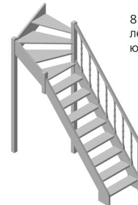
8. После установки и осадки лестницы весь крепеж затягивают окончательно.
