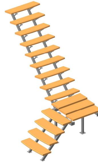
7. На собранный и закрепленный каркас устанавливают деревянные ступени (13 шт, поз. 8) и сборную площадку, состоящую из трех досок 900х300 мм (поз. 7). Ступени и площадка закрепляются саморезами 3,5х35 мм.
