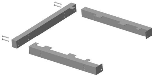
1. Сборку лестницы начинают со сборки площадки размером 900х900 мм из 3х металлических балок (поз. 2, 3, 4), скрепив каркас площадки болтами М8х80 мм (4 шт.)
